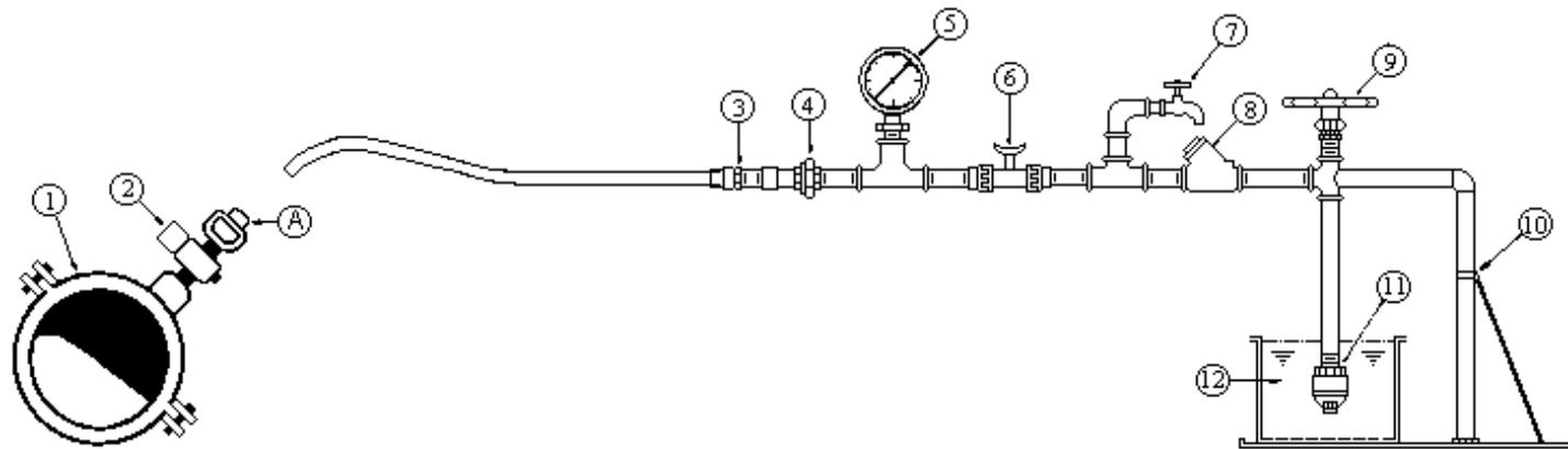
FIGURA No. 5 ESQUEMA DE PRUEBA DE ABRAZADERA/SILLETA Y VÁLVULA DE INSERCIÓN
