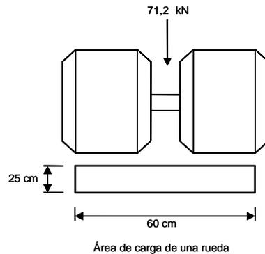
**a) Masa y dimensiones de un vehículo****b) Área de carga de una rueda**
