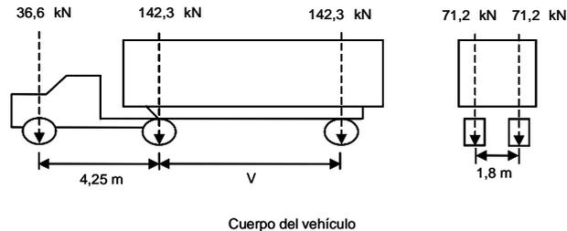
V = Dimensión que varía entre 4,25 y 9,0 m La dimensión a usar debe ser aquella que dé por resultado (La carga lateral y vertical que produzca los máximos momentos flexionantes en la estructura)
