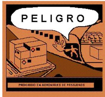
**9.8.8** La marca de manipulación para "LIQUIDOS CRIOGENICOS" que se indica en la figura No. 9 debe ser utilizada en todos los envases y sobreembalajes que se transportan en aeronaves, adicionalmente a la etiqueta de riesgo de "GAS NO INFLAMABLE" de la división 2.2. Dicha marca debe tener dimensiones mínimas de 74 mm x 105 mm, fondo: verde con recuadro, figura y texto en color blanco.
