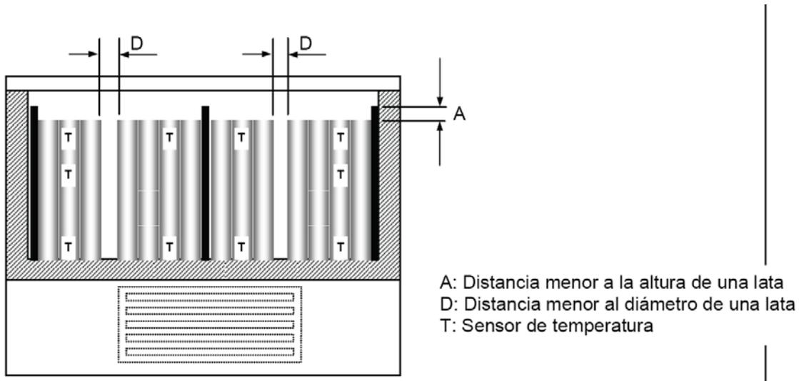
**E.4.2** Los sensores deben ser colocados en latas de las columnas adyacentes a aquellas que están en contacto con las placas frías, como se ejemplifica en las figuras anterior y siguiente:
