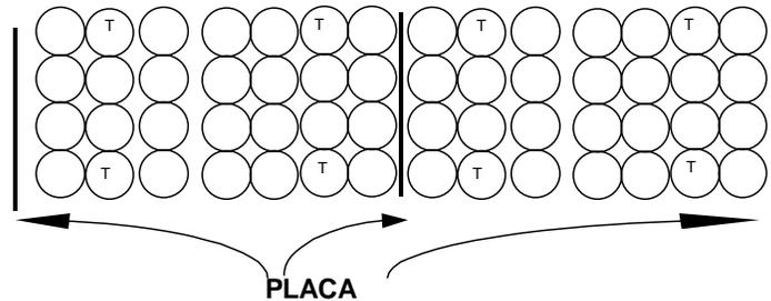
**E.4.3** Los sensores se deben colocar intercalados, de forma similar al caso de los enfriadores horizontales de circulación forzada de aire, colocando cada dos niveles un sensor en el centro del equipo, comenzando por el nivel uno.
