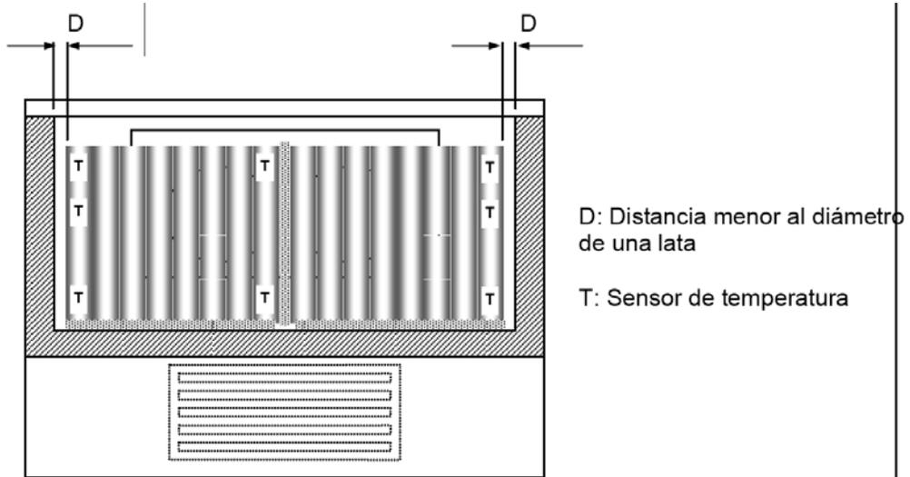
Para equipos con más de 5 niveles, intercalar los sensores colocando cada dos niveles 1 sensor en el centro del equipo, comenzando por el nivel superior.
