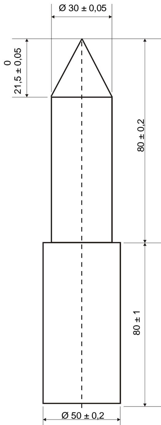
Figura 3. Probeta de prueba
