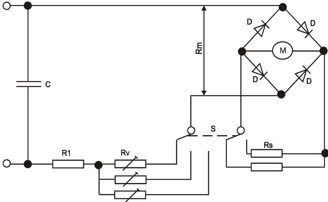
Figura 1 Circuito para medir corriente de fuga
