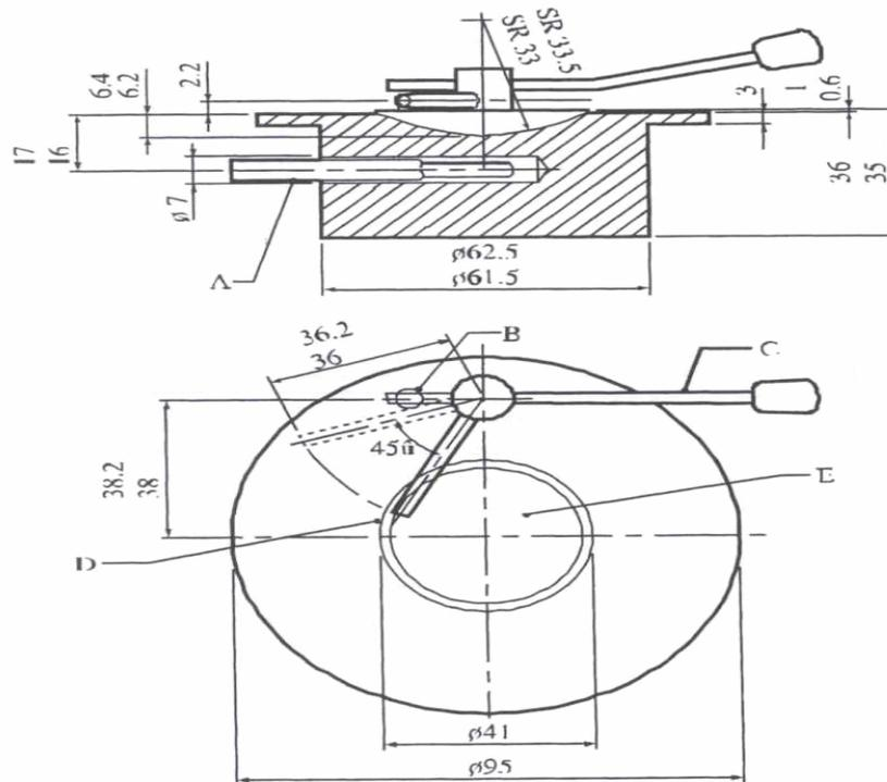
**Figura 1. Aparato para la prueba de Combustibilidad.**
