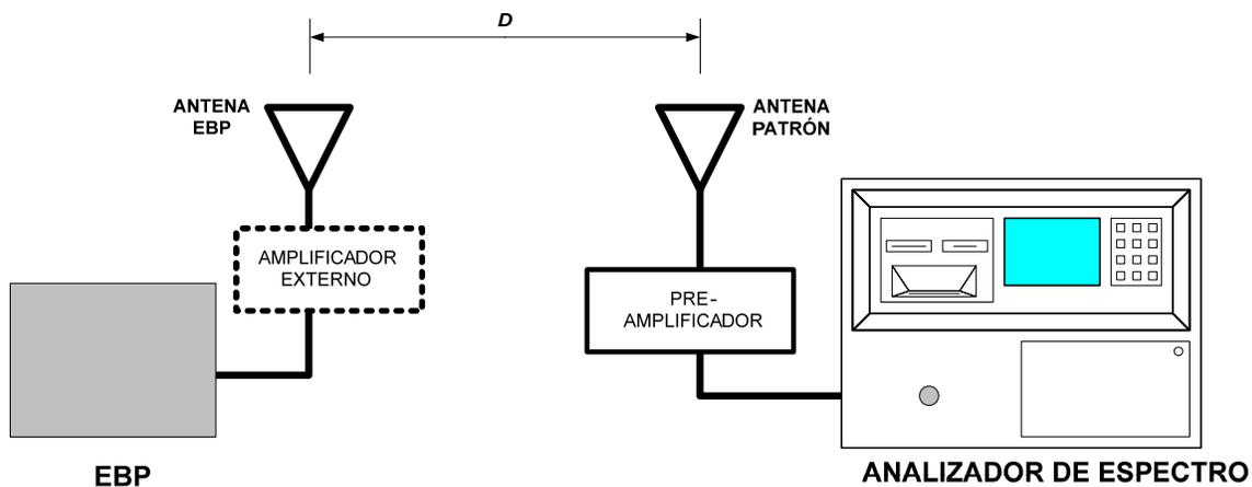
\* Amplificador de potencia de radiofrecuencia externo que se debe insertar sólo para los casos especificados en 4.1.3
