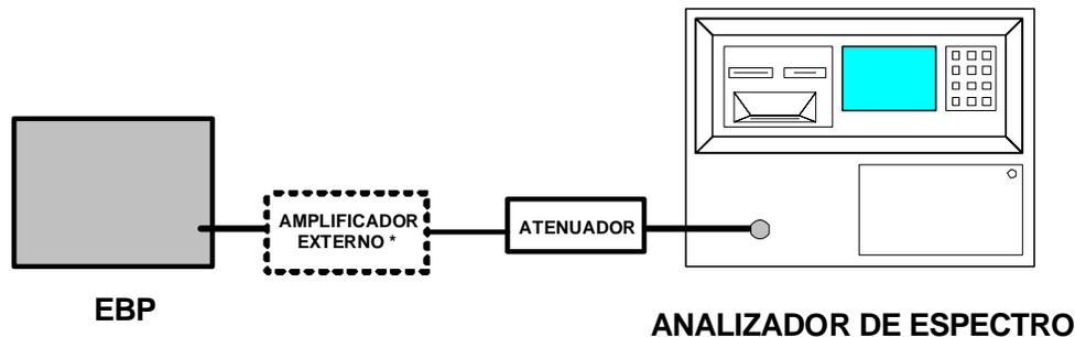
\* Amplificador de potencia de radiofrecuencia externo que se debe insertar sólo para los casos especificados en 4.1.3
