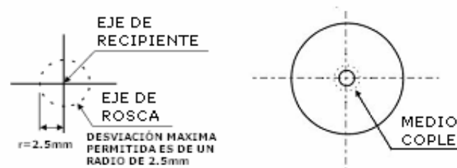
CONCENTRICIDAD DEL EJE DE LA ROSCA
