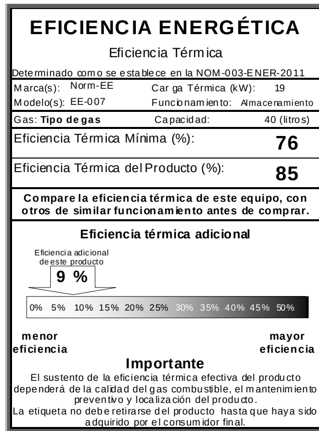
Figura 3.- Ejemplo de distribución de la información de la etiqueta de calentador de agua para uso doméstico o comercial
