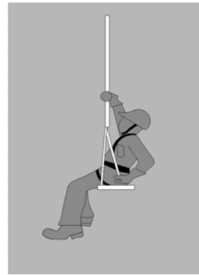
Sistema de ascenso/descenso controlado
