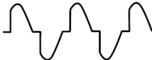
Figura 2.- Atenuador tipo corte de fase de la forma de onda de salida
