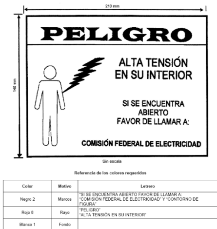
FIGURA 5 - Señal preventiva y de riesgo
