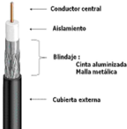
Componentes de un Cable Coaxial con Mensajero
