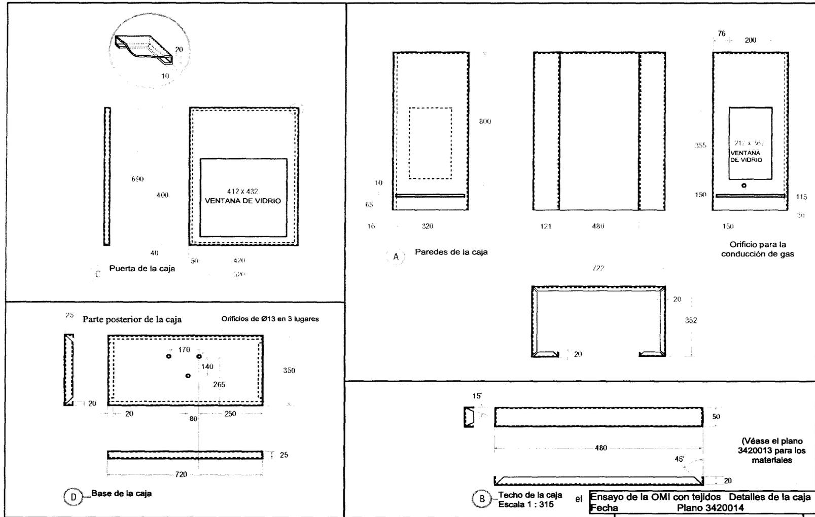
Figura 6 –Ensayo de tejidos: caja de ensayos
