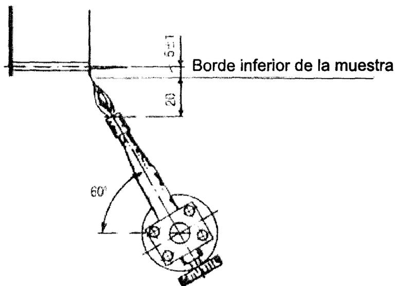
Figura 2 – Quemador de gas: posiciones del tejido
