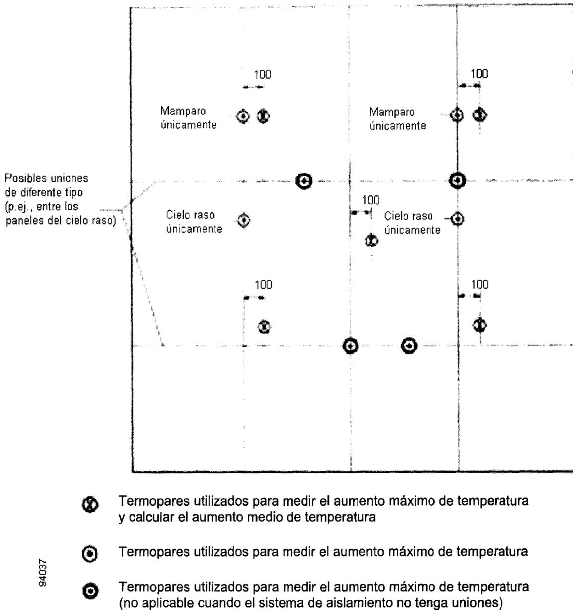
Figura 9 – Ubicación de los termopares en la cara no expuesta de las divisiones de clases “B” y “F”
