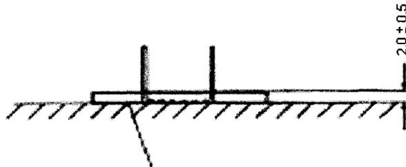
Almohadilla de aislamiento adherida a la superficie de la muestra sin adhesivo entre el disco de cobre y la superficie de la muestra o entre el disco de cobre y la almohadilla de aislamiento
