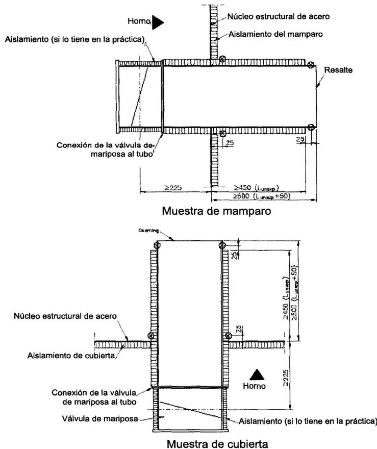
$L_{unexp}$  = Longitud de aislamiento necesaria para una válvula de mariposa sometida a ensayo
