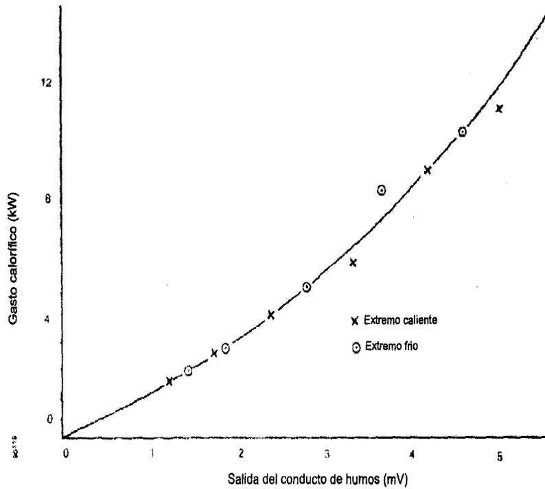
**Figura 9 – Calibración típica del conducto de humos**
