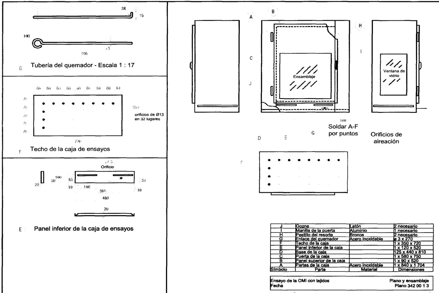
Figura 5 – Ensayo de tejidos: caja de ensayos
