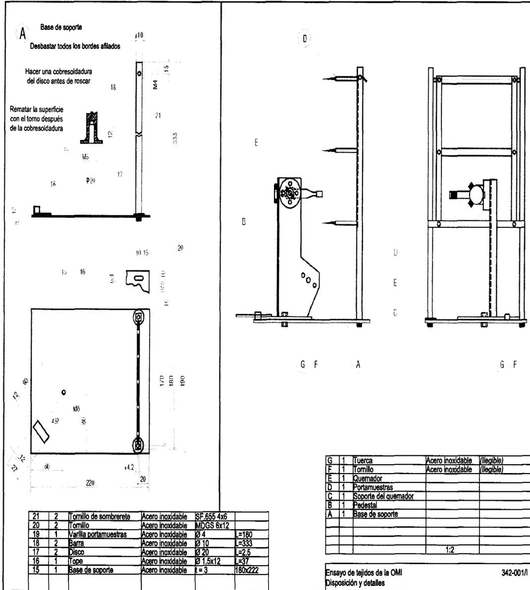
Figura 3 – Ensayo de tejidos: disposición y detalles
