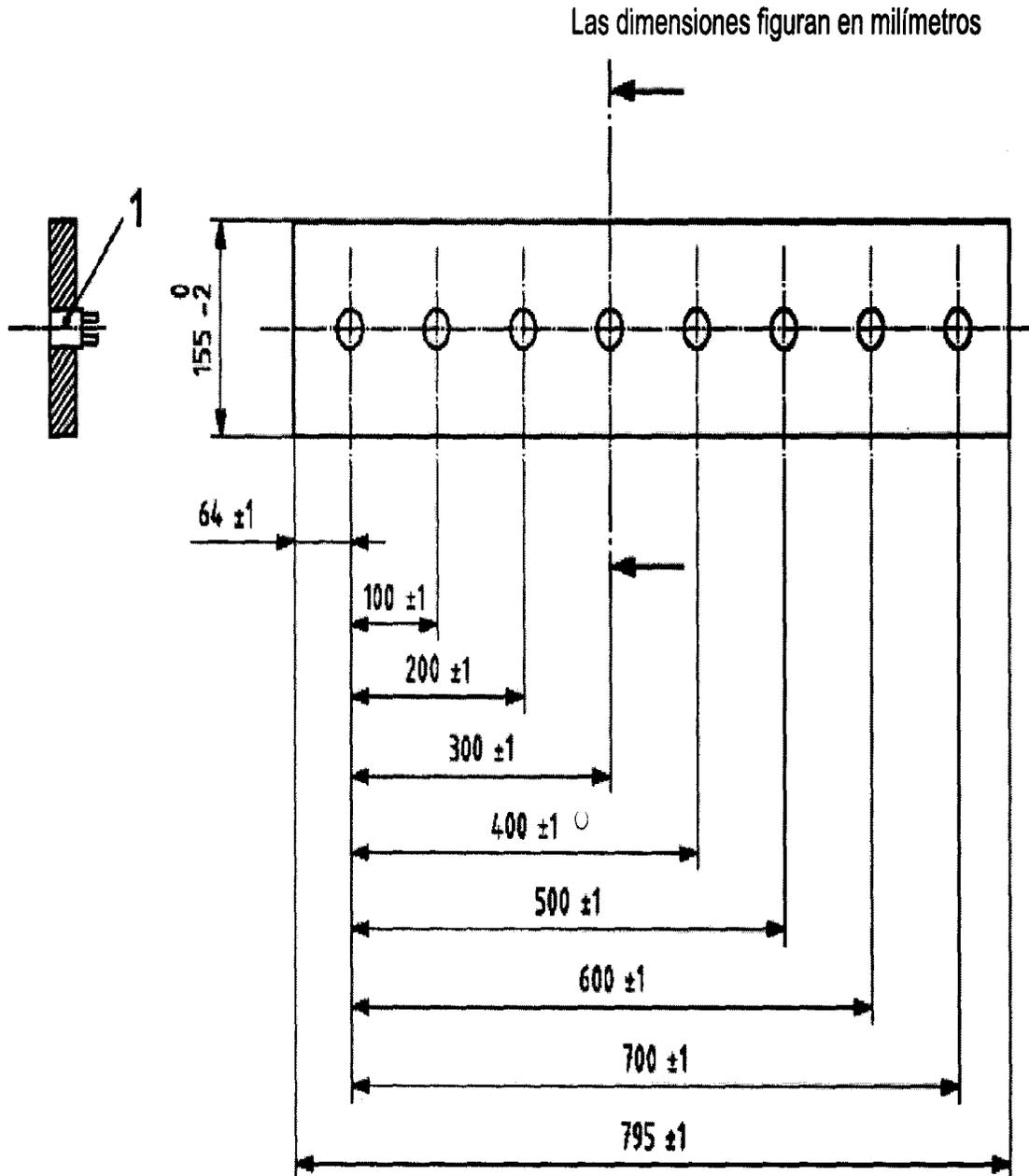
1 Medidor del flujo calorífico que calza ajustado en el orificio de 25 mm de diámetro (p. ej., para medir a 300 mm)
