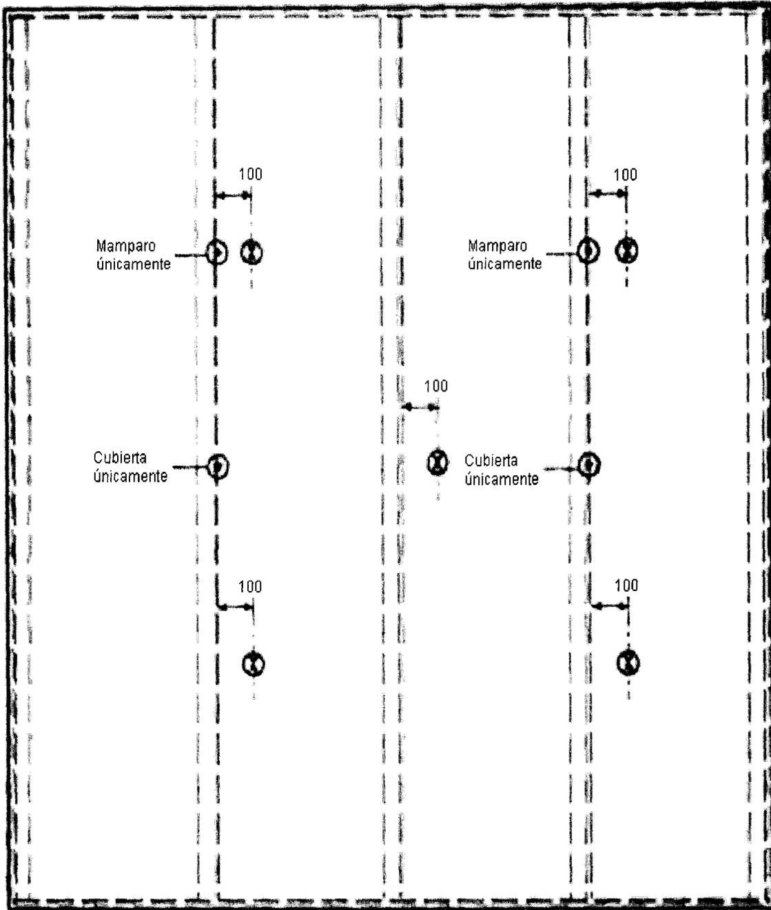
⊗ Termopares utilizados para medir el aumento máximo de temperatura y calcular el aumento medio de temperatura
