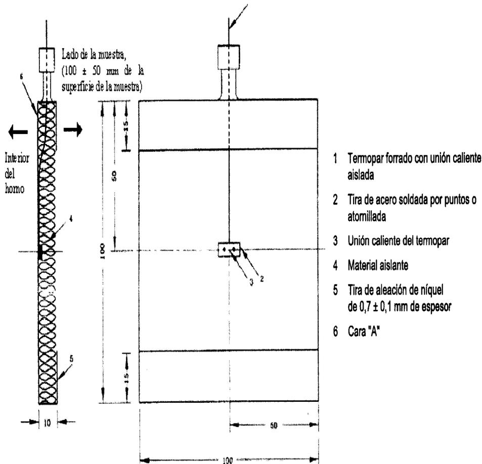
Figura 4 – Montaje de los termopares del horno
