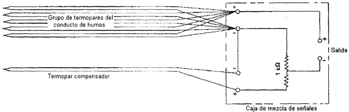
Figura 7 – Diagrama de un circuito de termopares
