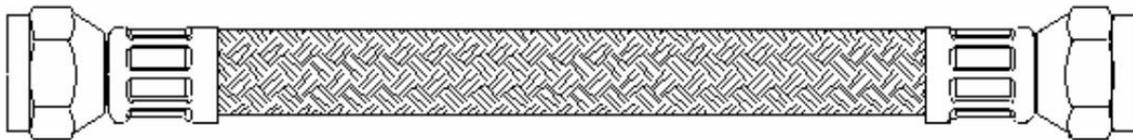
**Figura 3. Conexión flexible (rizo) Tipo 3 (ilustrativa, no limitativa)**
