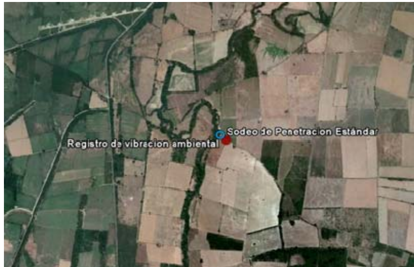
Figura 17 Estudios de vibración ambiental y geotécnico (sondeo de penetración estándar, SPT) realizados en ubicaciones contiguas, que se complementan en el cálculo de los efectos de sitio
