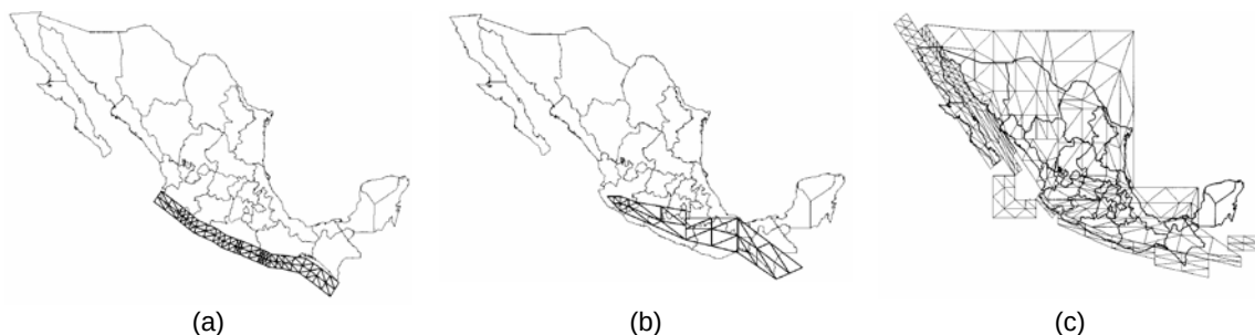
Figura 3 Fuentes sísmicas con las que se caracteriza la ocurrencia de sismos en México: (a) sismos de subducción (b), sismos de profundidad intermedia y (c) sismos superficiales
