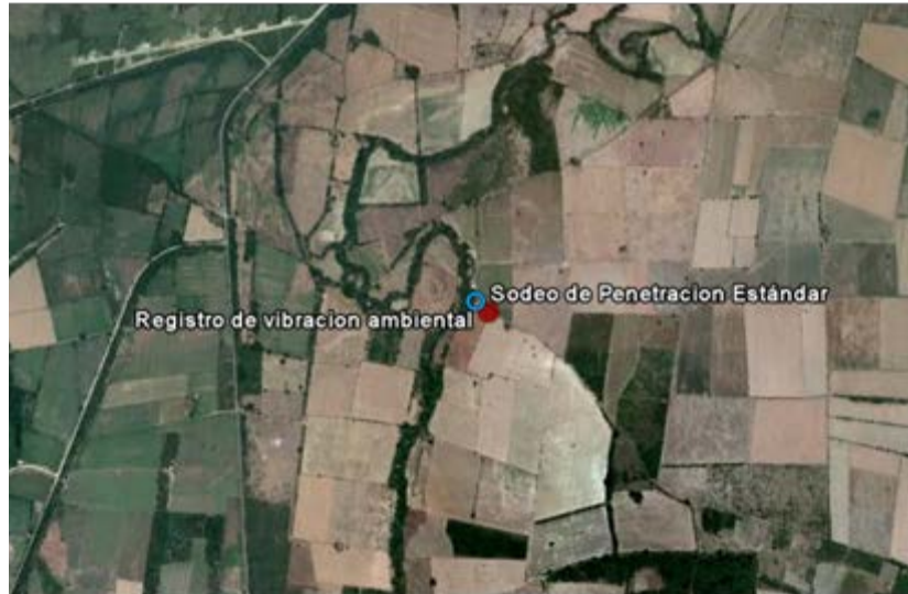
Figura 17 Estudios de vibración ambiental y geotécnico (sondeo de penetración estándar, SPT) realizados en ubicaciones contiguas, que se complementan en el cálculo de los efectos de sitio
