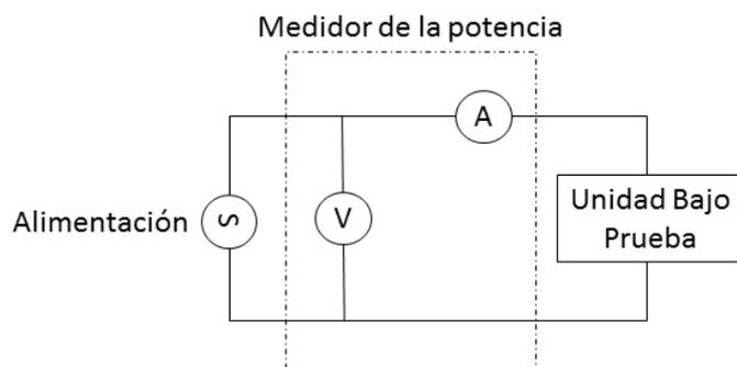
**Figura 1. Arreglo de pruebas para las mediciones de potencia eléctrica en modo de espera****Tabla 3. Área de la sección transversal para conductores eléctricos comúnmente utilizados y las caídas de tensión asociadas**
