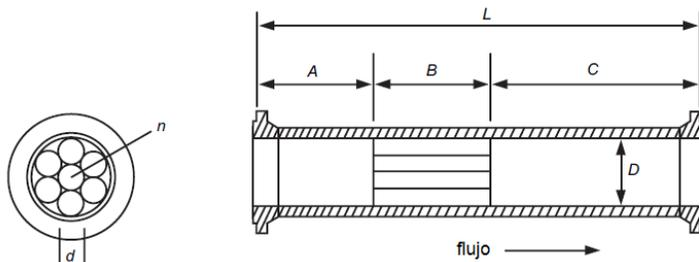
Nota: Esta figura muestra el ensamble instalado aguas arriba de la turbina. Aguas abajo del medidor se requiere una tubería recta de  $5D$
