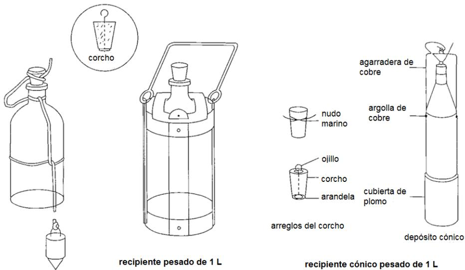
**Fig. 3** Recipientes para el muestreo en tanques verticales
