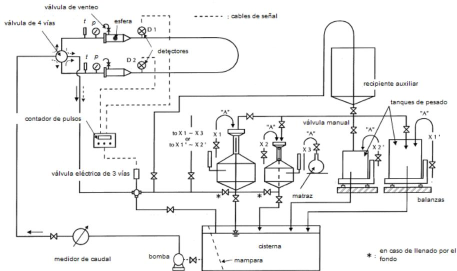
**Fig. 8** Diagrama esquemático de una instalación para calibración de un patrón de referencia tipo tubería (pipe prover o compact prover), por el método de desplazamiento de agua (adaptado de OIML R 119:1996).
