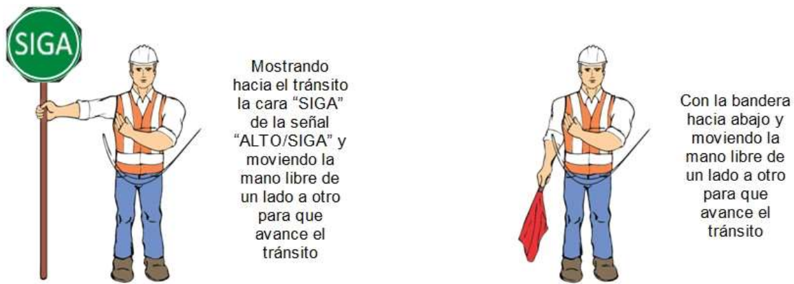
FIGURA 5.- Para que avance el tránsito
