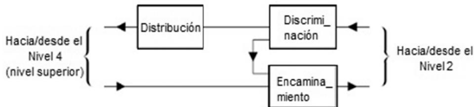
**FIGURA 25.- Encaminamiento, discriminación y distribución de mensajes.**
