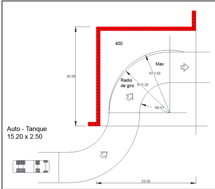
Figura 3. Radio de giro 10.4-10.8 m para una superficie de 400 m<sup>2</sup>, en esquina.
