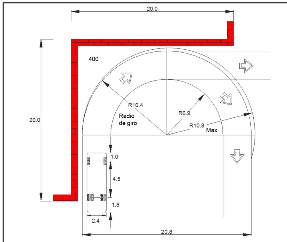
Figura 2. Radio de giro 12.20 -12.56 m para una superficie de 400 m<sup>2</sup>, en esquina.
