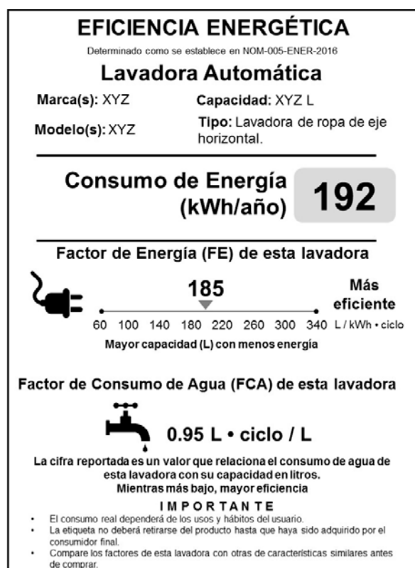
Figura 1B Ejemplo de distribución de la información de la etiqueta de lavadoras de ropa electrodomésticas automáticas de eje horizontal.
