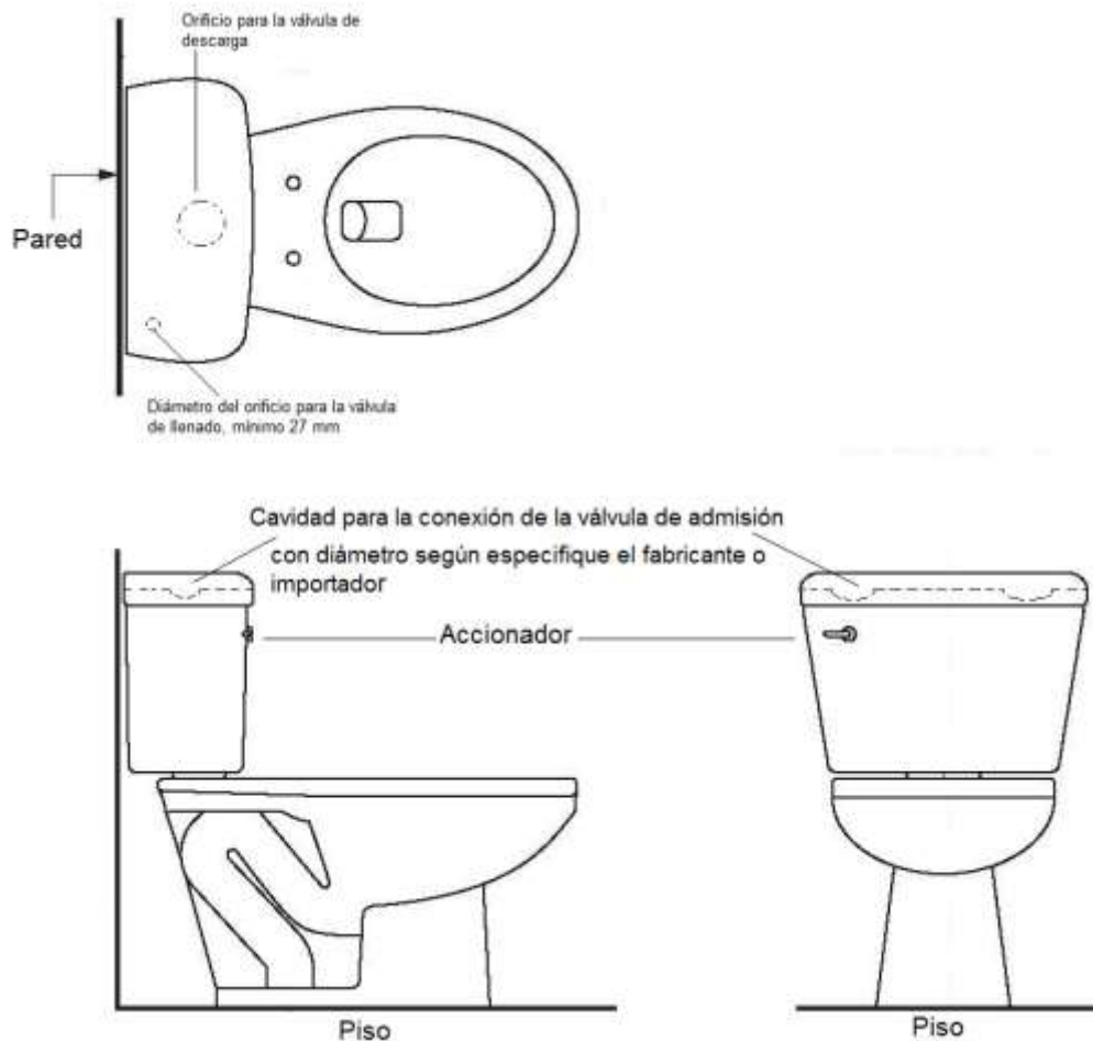
Figura 6.- Orificios para las válvulas en tanques de descarga por gravedad.
