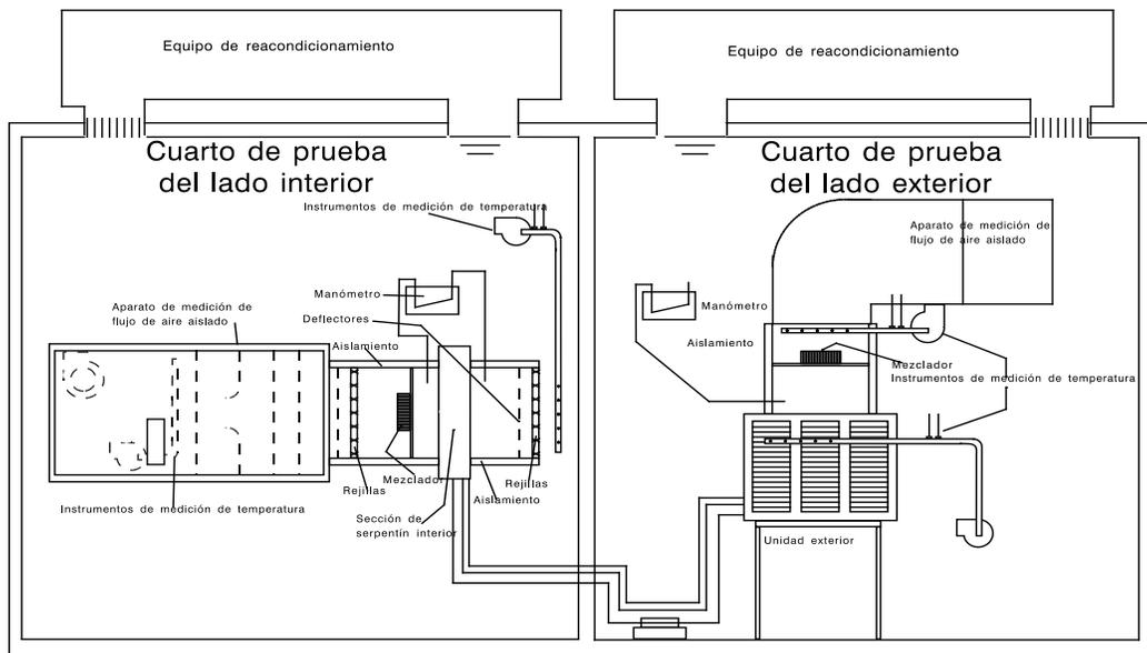
Figura A.1 - Método de túnel aire entalpía
