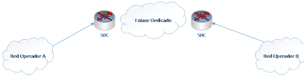
• Figura 1: Topología de interconexión SBC-SBC
