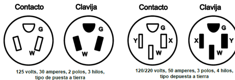
Figura 552-44(c)(1).- Configuraciones para contactos y clavijas del tipo con puesta a tierra.
