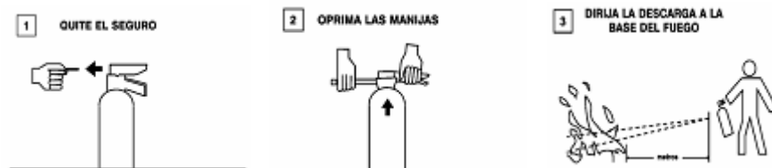
Figura 3-Ejemplo de imágenes y leyendas que ilustran la nemotecnia de operación de los extintores portátiles
