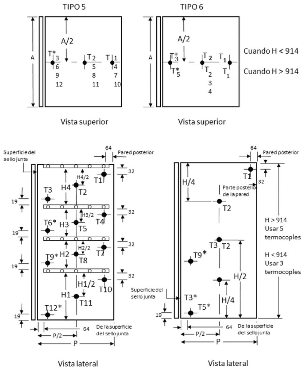
Nota 1: Si un saliente en el lado interno de la puerta interfiere con la localización del sensor de temperatura, el sensor se colocará en un lugar lo más cercano al especificado. Para los tipos 1, 2, 3 y 4 la altura debe ser medida desde la parte inferior de la superficie interna (o desde la parte de arriba de un tripié, si se cuenta con él) hasta el plano definido por la superficie del sellado de la junta.
