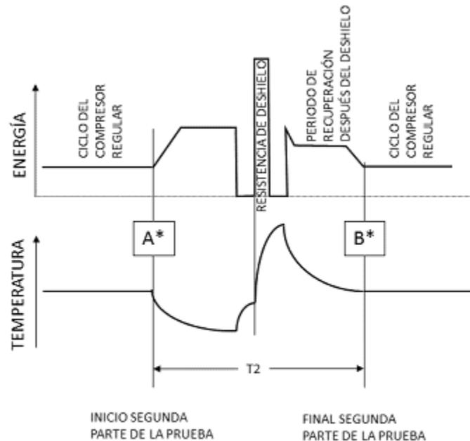
\*Temperatura(s) promedio del compartimiento en los tiempo A y B debe estar entre  $-17,5\text{ }^{\circ}\text{C}$  de la temperatura (s) promedio de la primera parte de la prueba
