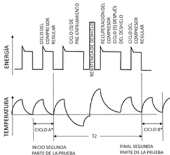
\*Temperatura(s) promedio del compartimiento durante los ciclos A y B debe estar entre  $-17,5^{\circ}\text{C}$  de la temperatura (s) promedio de la primera parte de la prueba
