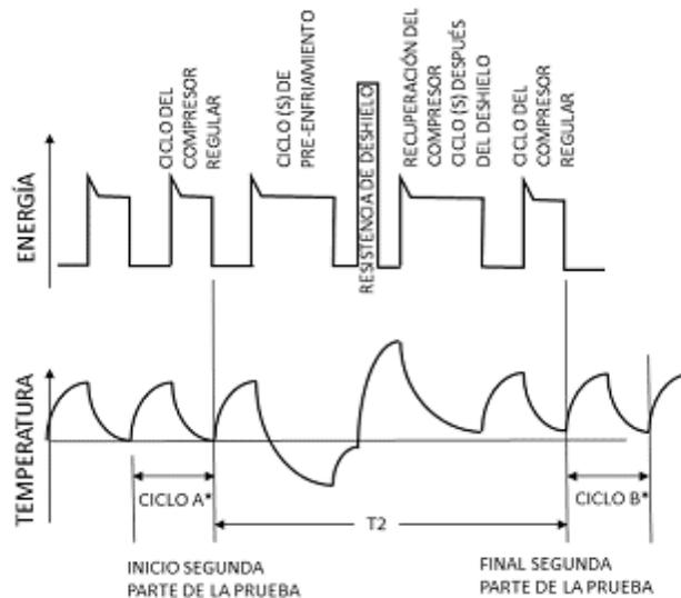
\*Temperatura(s) promedio del compartimiento durante los ciclos A y B debe estar entre -17,5 °C de la temperatura (s) promedio de la primera parte de la prueba
