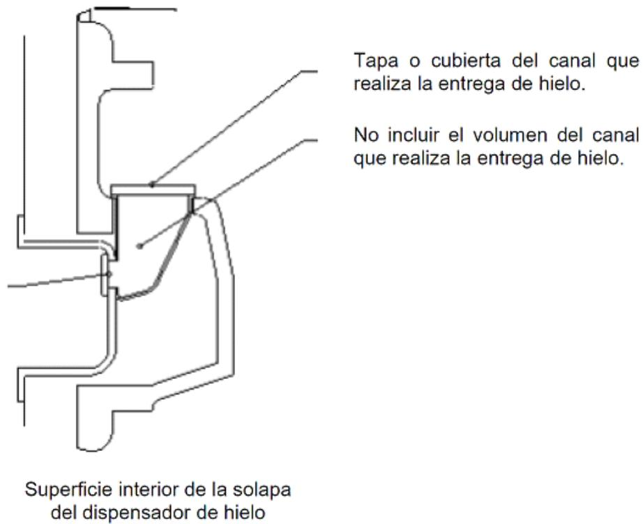
**Figura C.2.** Esta figura muestra un modelo con congelador en la parte superior, pero aplica a todos los modelos con dos puertas, con congelador en la parte inferior, FF, FZ, etc. Todas las deducciones son lo mismo. Ver siguientes figuras para la explicación de la unidad dispensadora.
