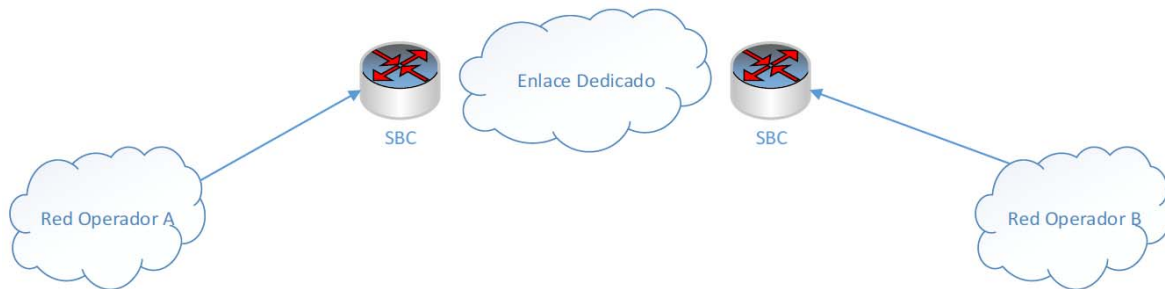
Figura 1: Topología de interconexión SBC-SBC
