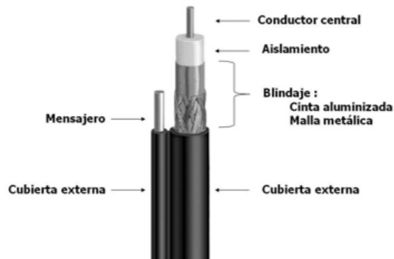
Componentes de un Cable Coaxial con Mensajero
