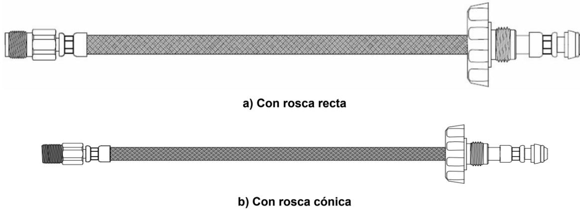
**FIGURA 2-Conexión integral flexible Tipo 2 (ilustrativa no limitativa)**
