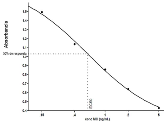
**Fig. B.1.1-1.** Curva de calibración de ELISA con cálculo de la EC<sub>50</sub>. El eje x se encuentra en escala logarítmica.
