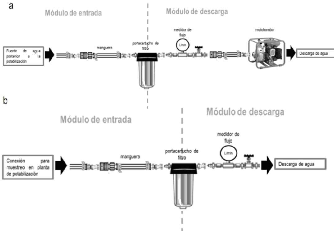
**Fig. B.2.1-1** Dispositivo de muestreo. 1a) en caso de existir conexión para muestreo a la salida de la planta de potabilización. 1b) en caso de no existir conexión para muestreo a la salida de la planta de potabilización.
