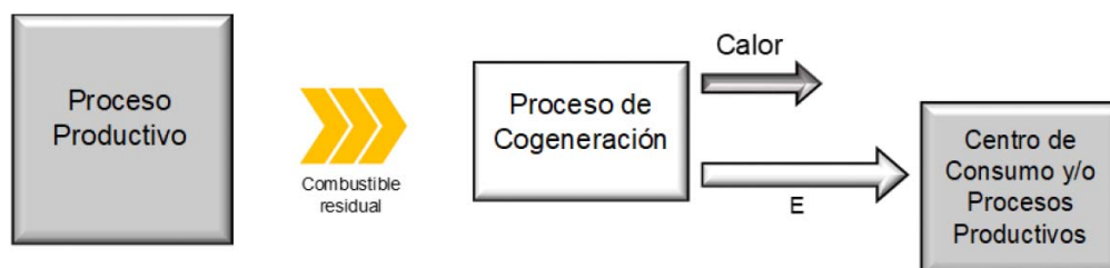
Figura 5 - Proceso de Cogeneración tipo C
