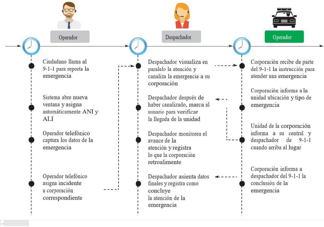
**Figura 8-Diagrama básico CAD**
