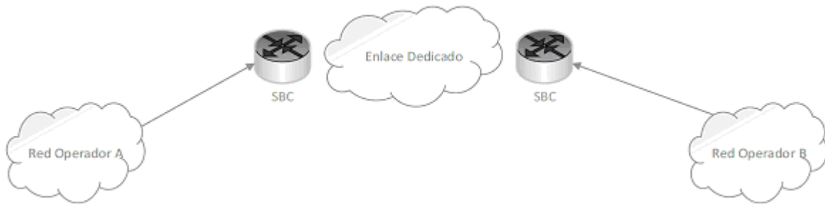
Figura 1: Topología de interconexión SBC-SBC
