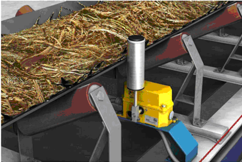
Figura B. 5 - Pesaje en banda de bagazo de caña de azúcar.
