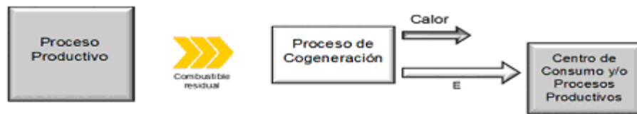
Figura 5 - Proceso de Cogeneración tipo C
