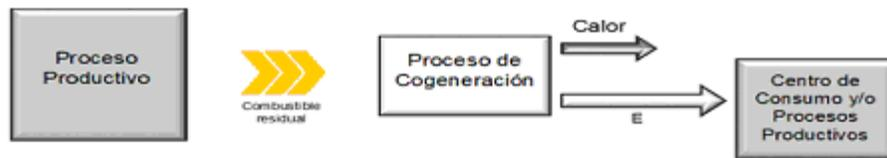
**Figura 5 - Proceso de Cogeneración tipo C**
