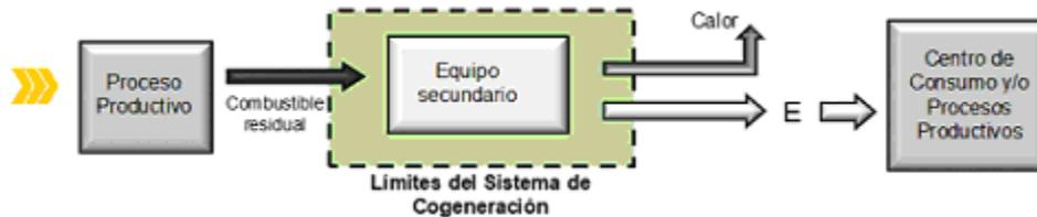
**Figura 9 - Límites del proceso de Cogeneración tipo C**
