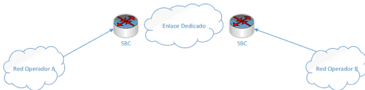
Figura 1. Topología de interconexión SBC-SBC
