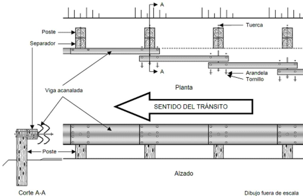
FIGURA 18.- Instalación de vigas acanaladas de acero
