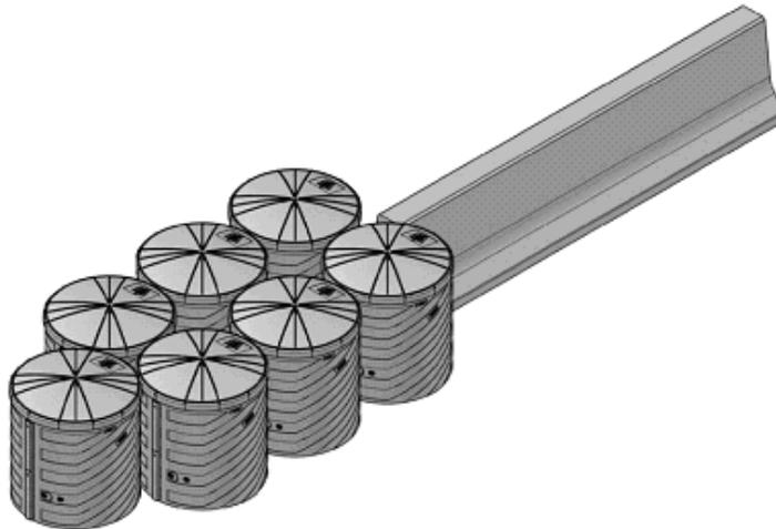
FIGURA 27.- Sección de amortiguamiento no redireccionable (OD-4.4.1/NR)
