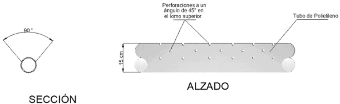
Figura A.2. Vista frontal del sistema de captación de lixiviados
