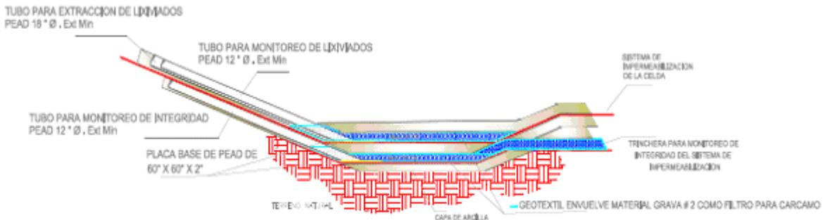
El espesor y diámetro mínimo de las tuberías para extracción de lixiviados, se deben revisar en la ingeniería de la celda para determinar esfuerzo y capacidad de captación.
