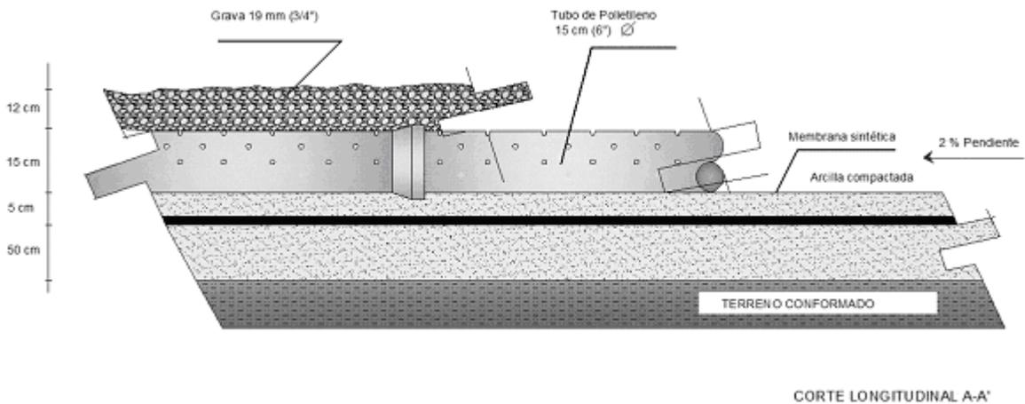
**Figura A.3.1. Vista lateral del Pozo de monitoreo en diagonal de extracción de lixiviados y de extracción secundario.**
