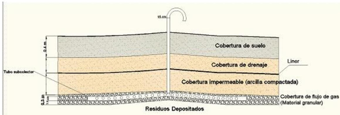
**4.2.3.2.** El material de los tubos de venteo puede ser polietileno de alta densidad, polipropileno o cualquier otro polímero que resista la corrosión; sin embargo, éstos deben terminar en cuello de ganso.
