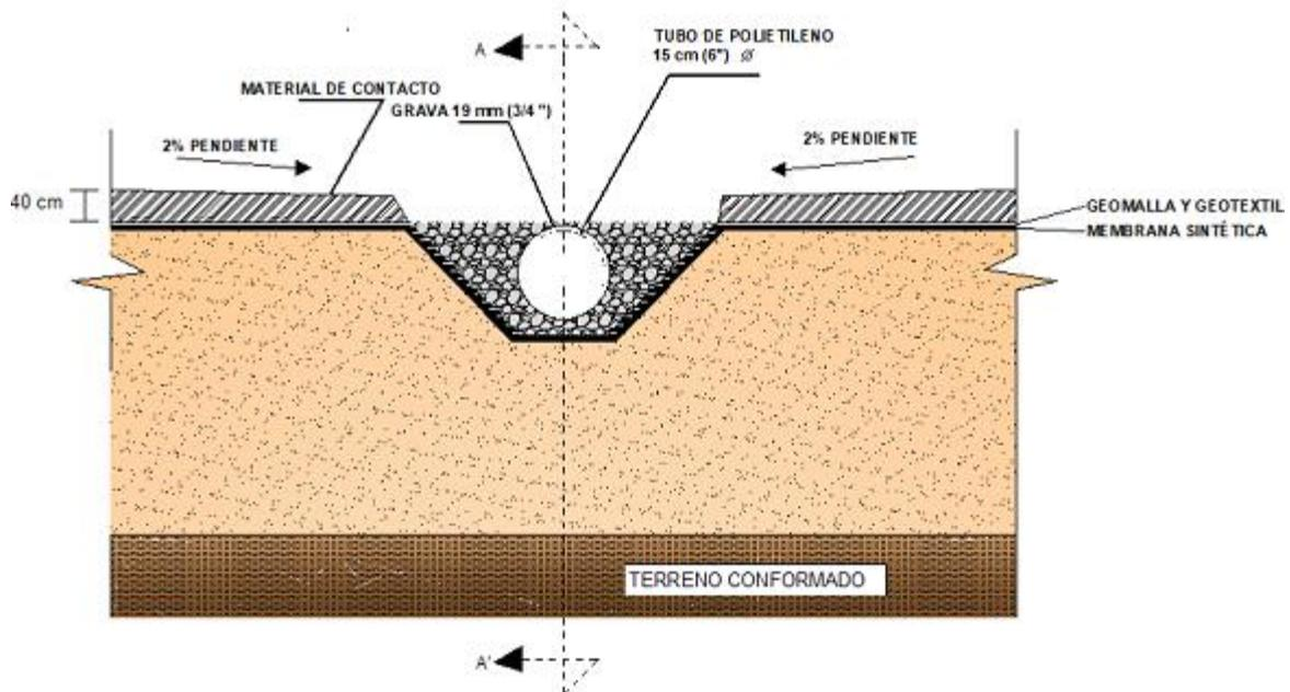
**Figura A.2.1 Vista frontal del sistema de captación y extracción secundario**
