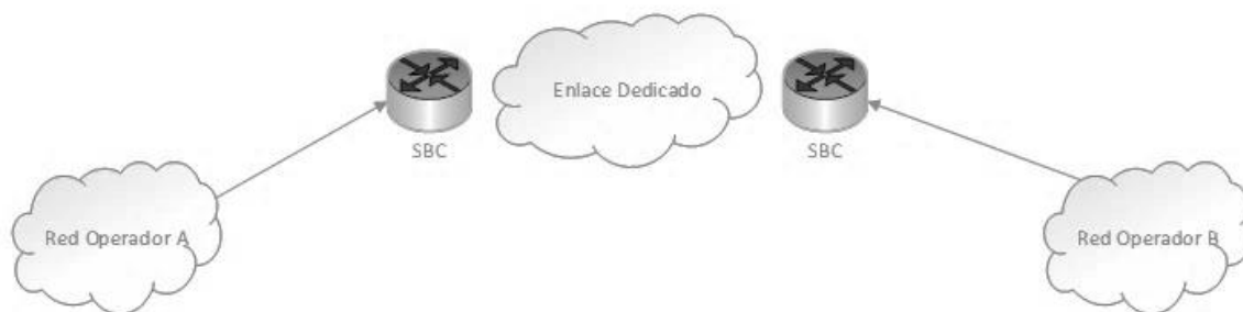
Figura 1. Topología de interconexión SBC-SBC
