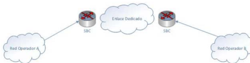
Figura 1. Topología de interconexión SBC-SBC
