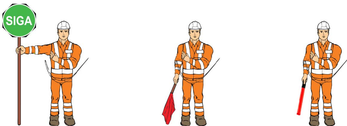
FIGURA 13.- Para alertar y disminuir la velocidad del tránsito
