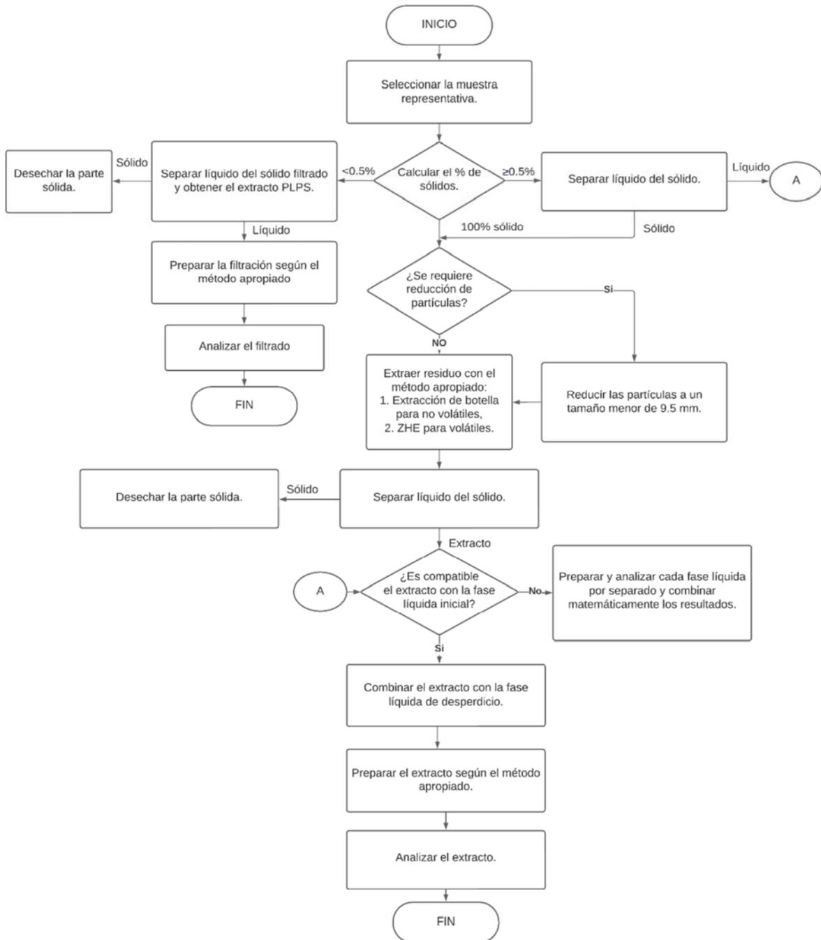
**Figura C.2 Procedimiento de lixiviación de precipitación sintética**
