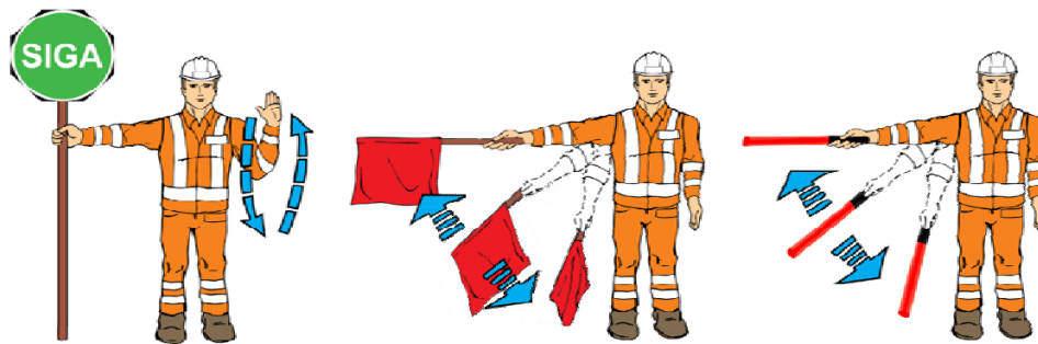
Alertar y disminuir la velocidad del tránsito
