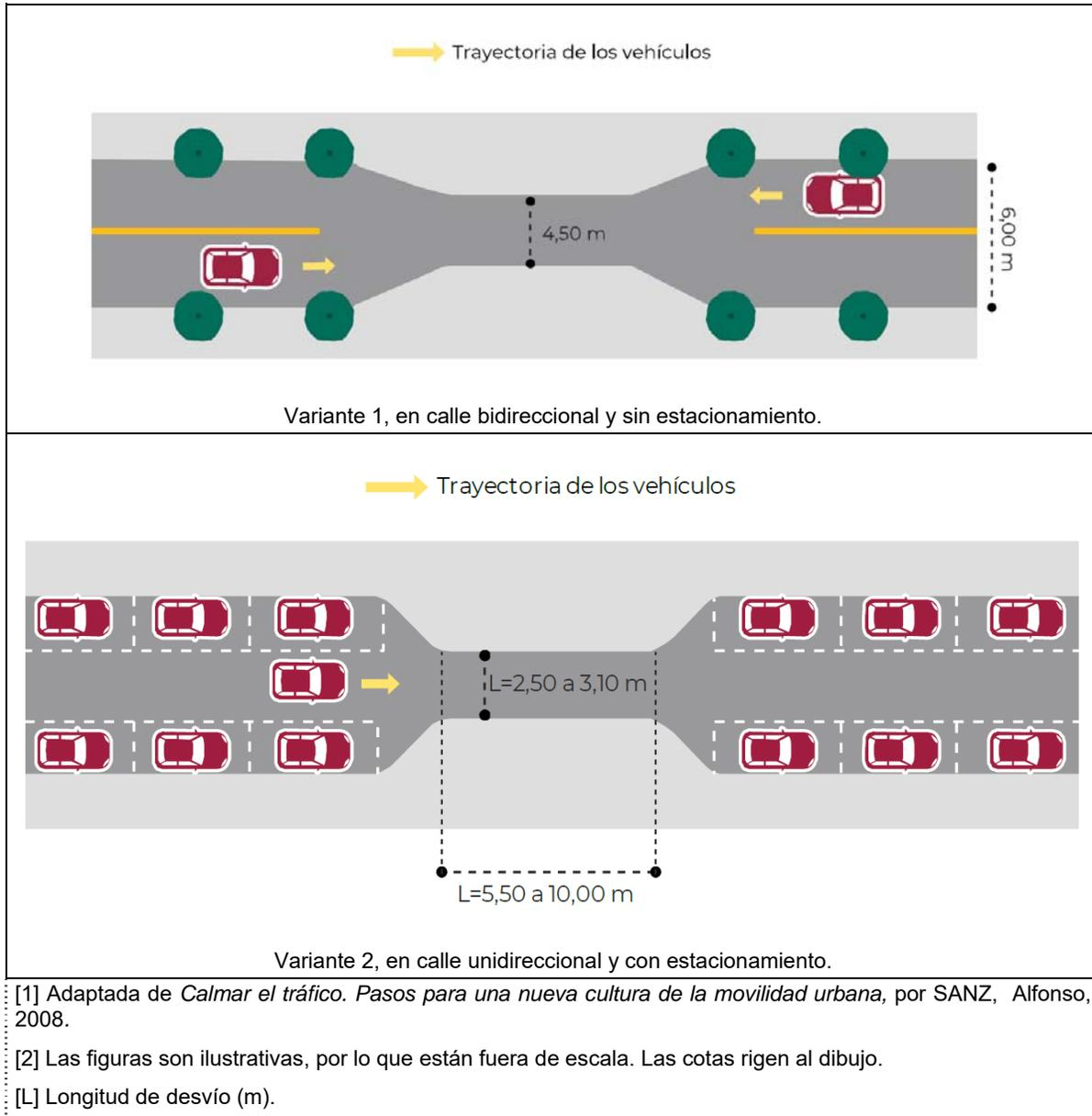
El estrechamiento lateral se puede complementar con pavimentación especial a efecto de reducir la velocidad si existen flujos equilibrados en ambos sentidos de circulación, como se muestra en la figura 107. Las dimensiones recomendadas son las siguientes:
