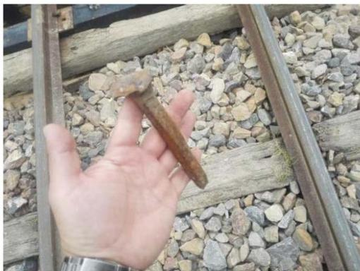
Figura 16 Defecto de no fijación en el durmiente
