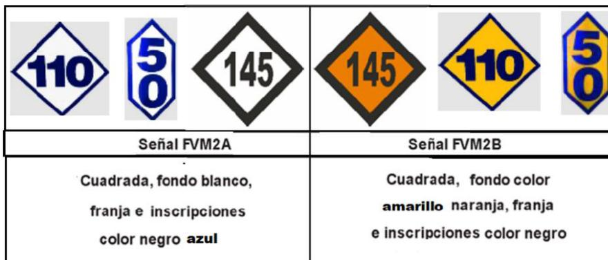
Figura 27 Señales FVM2A y FVM2B, velocidad máxima
