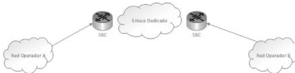
Figura 1. Topología de interconexión SBC-SBC
