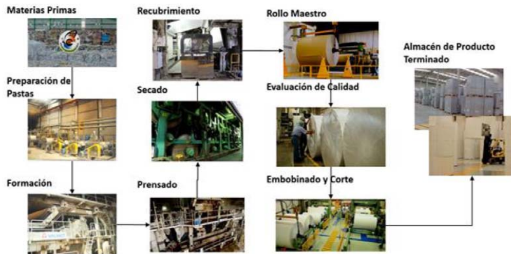
Diagrama de flujo del proceso de producción de cartoncillo nacional
